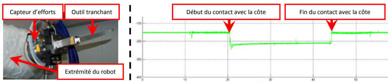
Fig. 13 : Exemple de relevé d'efforts (capteur d'efforts 6 axes monté sur l'effecteur du robot) lors du suivi d'un os par la lame de l'outil du robot
