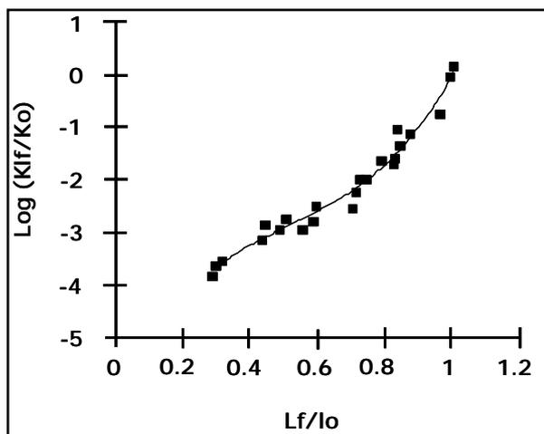
**Figure 2** : Evolution du module d'élasticité du collagène en fonction de son état de contraction final après chauffage à 80°C. (Snowden *et al* 1977).
