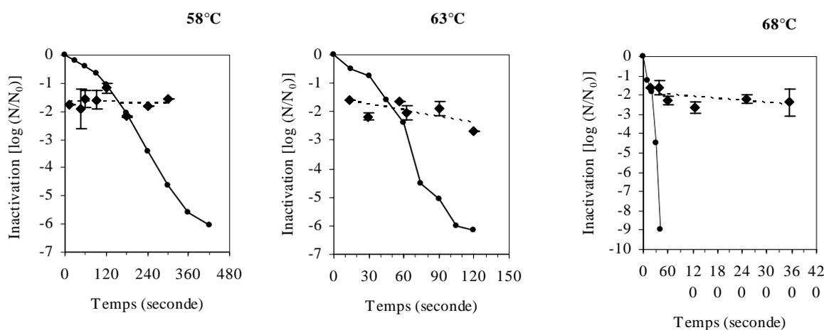
**Figures 3** : Comparaison des cinétiques de destruction de *L. innocua* CLIP 20-595 en suspension dans du tryptone-sel (●) et adhérente à la surface de coupons de Téflon® (◆) à différentes températures.
