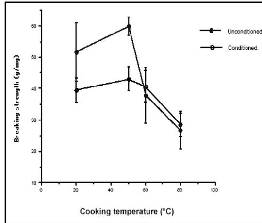
**Figure 5** : Modification de la résistance du pérимыsium avec la température de chauffage.
